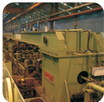
水壓測試 Hydrostatic Test
